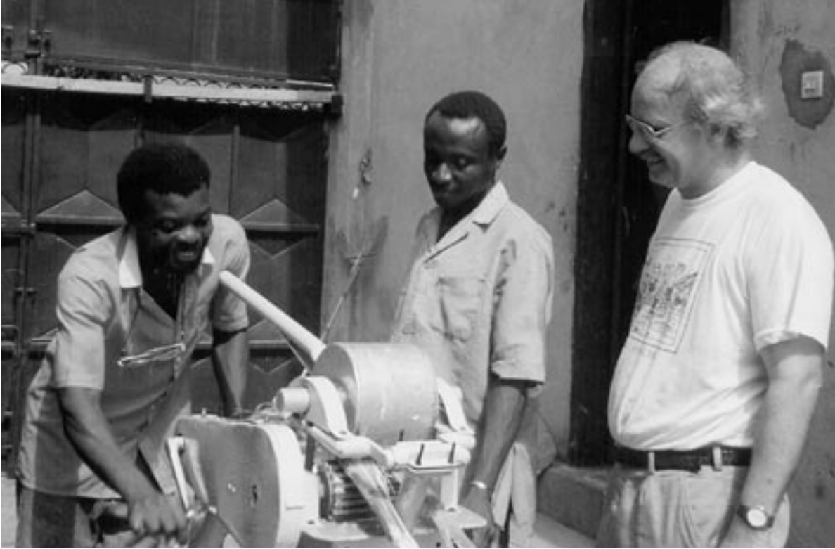
Die Zuckerrohrpresse wurde in Privatinitiative entwickelt und gebaut.
