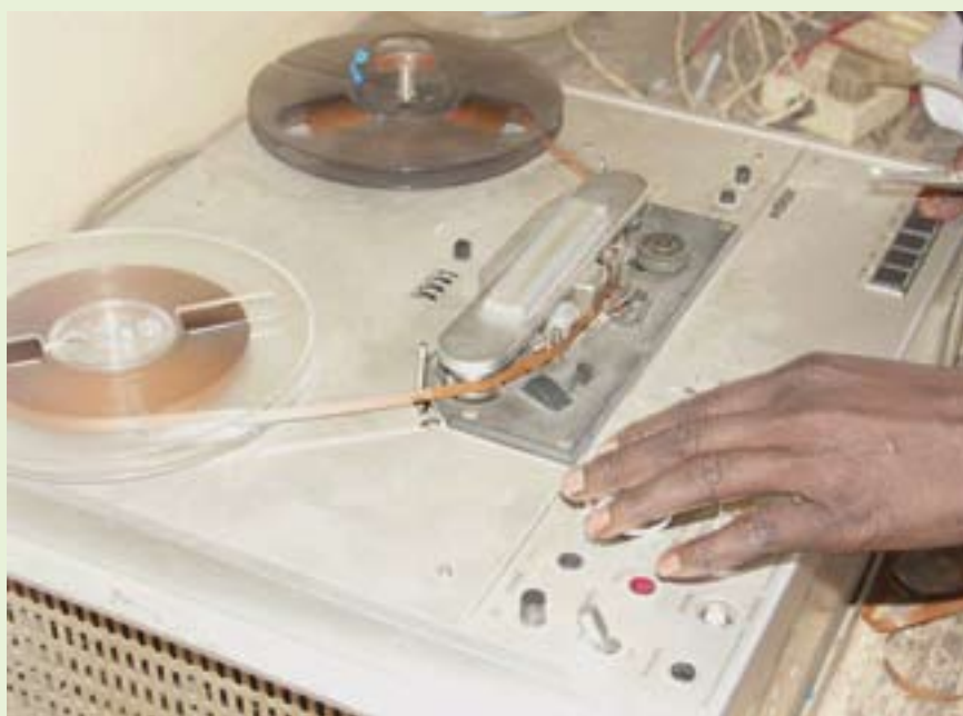
Schnitt einer Radiosendung (oben) mit der Schere an einem Tonbandgerät – viele davon sind seit über 20 Jahren im Einsatz.
