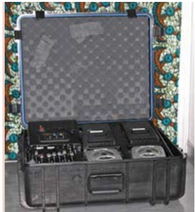
Der Radiokoffer der Fa. Wantok enthält einen UKW-Sender, ein Mischpult, zwei Kassettenrecorder, zwei CD-Player, zwei Mikrofone, Kopfhörer und Kabel. Damit kann eine dörfliche Radiostation betrieben werden.
