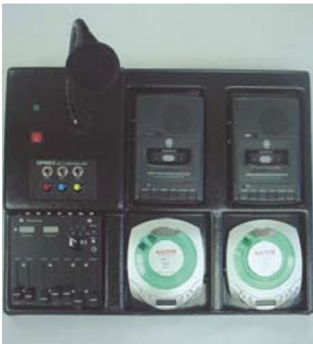
Der Radiokoffer der Fa. Wantok enthält einen UKW-Sender, ein Mischpult, zwei Kassettenrecorder, zwei CD-Player, zwei Mikrofone, Kopfhörer und Kabel. Damit kann eine dörfliche Radiostation betrieben werden.
